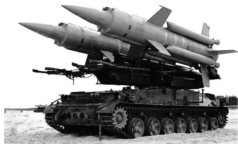
**Самохідна пускова установка 2П24 зенітно-ракетного комплексу «Круг»**
