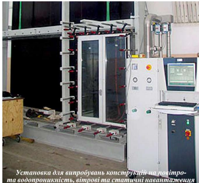
Установка для випробувань конструкцій на повітряно-водопроникність, вітрові та статичні навантаження
