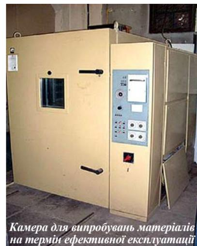
Камера для випробувань матеріалів на термін ефективної експлуатації
