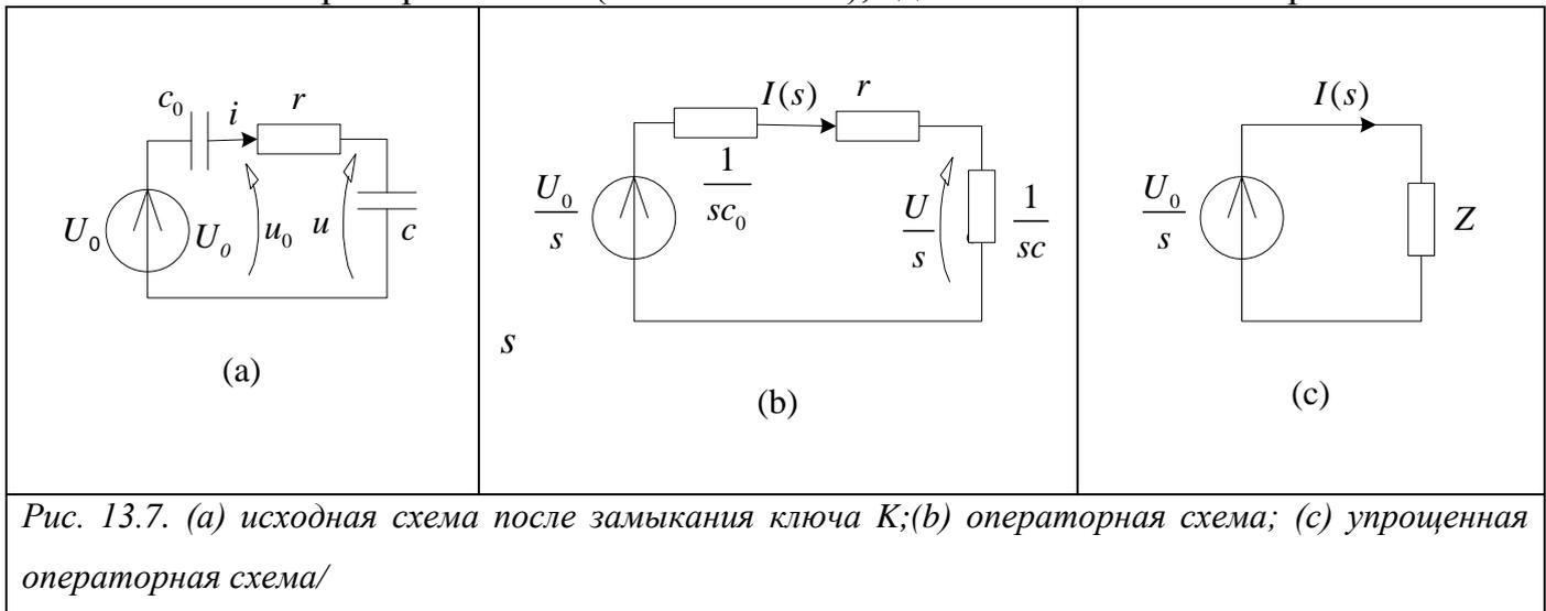
Рис. 13.7. (а) исходная схема после замыкания ключа К; (б) операторная схема; (с) упрощенная операторная схема/
