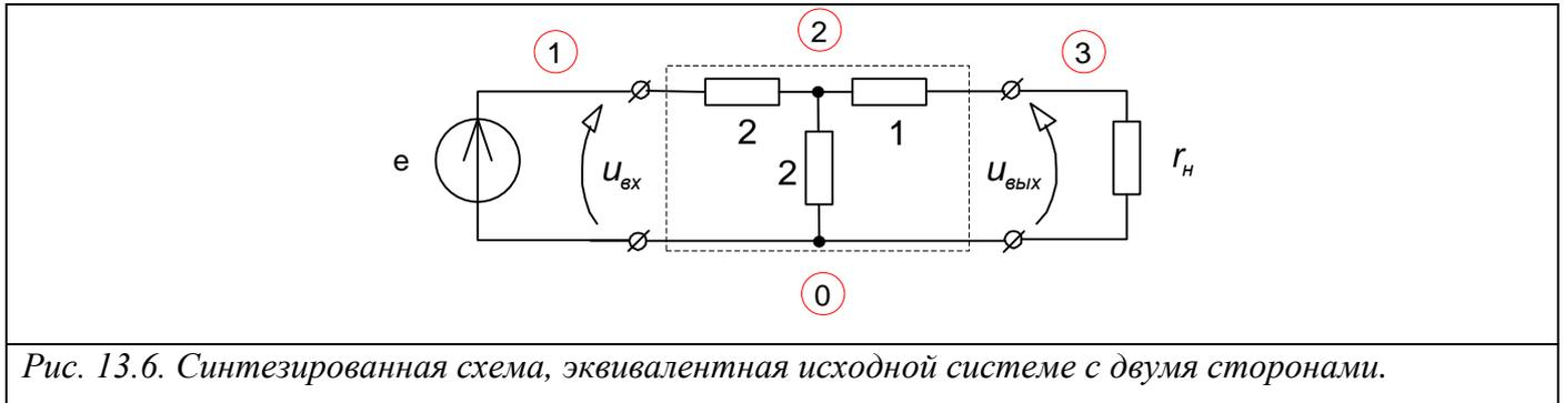
Рис. 13.6. Синтезированная схема, эквивалентная исходной системе с двумя сторонами.
