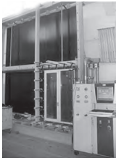
Установка для випробувань огороджувальних конструкцій на повітро- та водопроникність, вітрові та статичні навантаження
