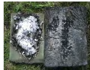
Випробування модельного зразка тари, обробленого захисним покриттям, при дії полум'я магнію
