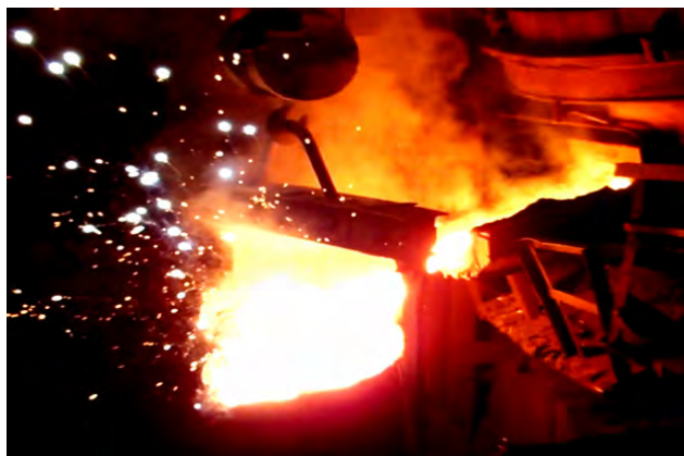
Процес позапічної десульфурзації чавуну магнієм, відновленим з оксиду в об'ємі розплаву за рахунок тепла паралельних хімічних перетворень
