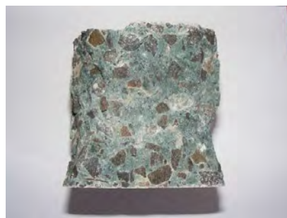
Руйнування заповнювача після випробування бетону
