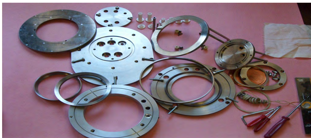
Різнманітні покриття, осаджені іонно-променевою розпилювальною системою
