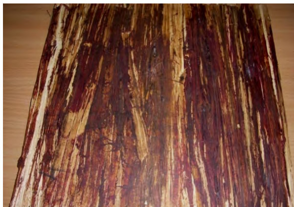
Тришаровий деревинно-композиційний матеріал на основі розчавлених гілок тополі з перпендикулярним напрямком волокон
