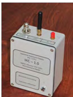
Електронний блок сенсора напруженості електричного поля атмосфери та приклад прогнозу на місцевості
