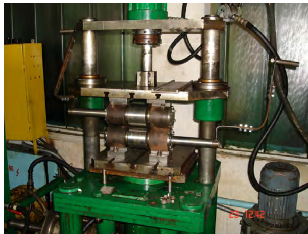
Експериментальний зразок установки з гідроімпульсним приводом для віброударного зневоднення відходів харчових виробництв
