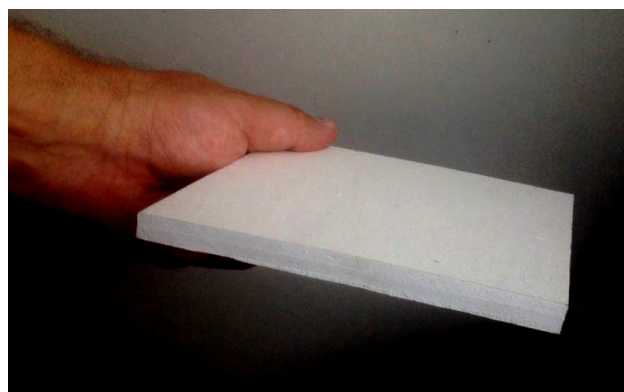
Зовнішній вигляд прототипу негорючого теплозахисного покриття товщиною 11 мм
