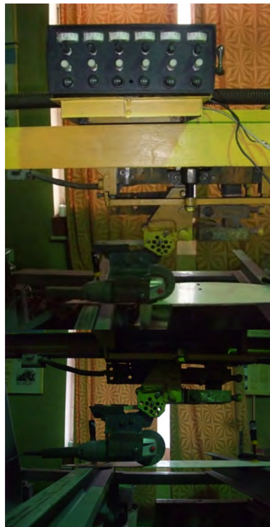
Робоче обладнання, закріплене на стенді для вимірювання сил очищення поверхонь
