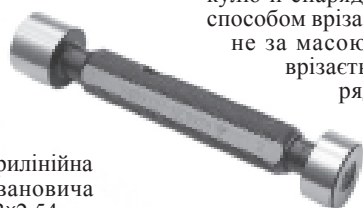
Калібр-корок гладкий (ліворуч прохідний, праворуч - непрохідний)
